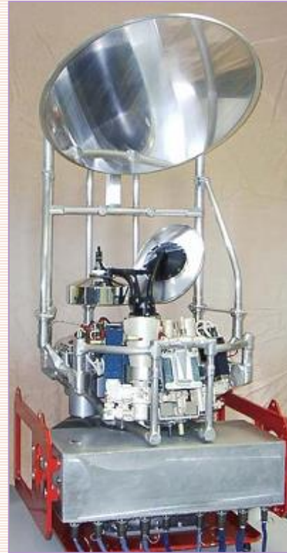
Скануюча дзеркальна антена для панорамного багатодіапазонного радіометра космічного апарата «СІЧ-1»
