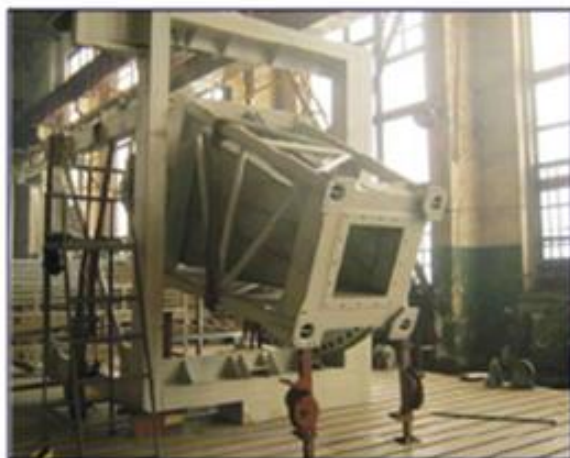
Завантажувальний механізм машини
