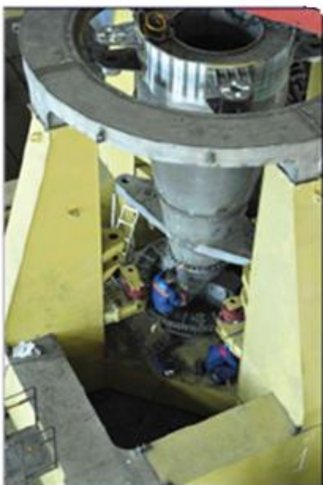
Контрольне збирання поворотного механізму завантажувальної машини
